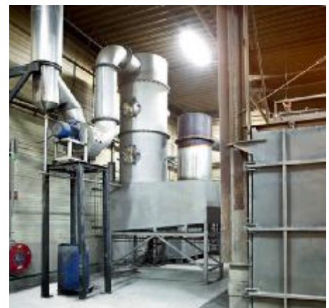
Essentielle Bestandteile des „SULEP“-Verfahrens sind der Gaswäscher (links) und der Ofen (rechts) zur thermischen Entlackung
